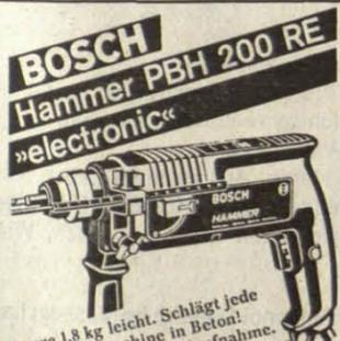
Ganze 1,8 kg leicht. Schlägt jede Schlagbohrmaschine in Beton! SDS-plus-Bohrer-Schnellaufnahme. Pneumatisches Hammerwerk. Steuerung Electronic. Rechts-/Linkslauf. 420 Watt. Sicherheitskupplung. Max. Bohr-ø in Beton 16, Stahl 13, Holz 30 mm.
